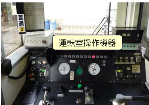
運転士が急な体調不良等で運転操作が不能になった場合に列車を自動的に停止させる「運転士異常時列車停止装置」を全車両に設置し安全性を向上させております。
