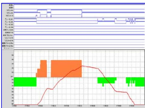
列車の運転の状況を記録するための、「運転状況記録装置」を設置しました。この装置は、列車の速度、時間及び制御装置の操作状況等を記録するもので、常総線では2015年度末、50両に設置（96パーセント）が完了しております。
