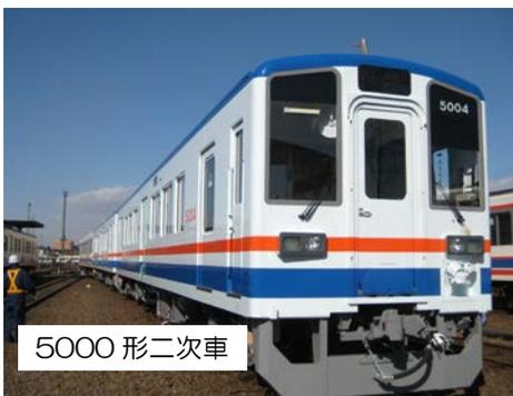
5000形は常総線で2009年度より運行を開始し、ご好評をいただいております。現在、4両在籍しております。今後も同形の導入を進めていくほか、他車両については、大修理工事の際、新造車両と同様にバリアフリーとして乗降口の床の色を黄色にするなど目の不自由な方にも利用しやすい車両にしています。2015年度は、排煙の少ないエンジンへの交換や客室内の蛍光灯をLED化し環境にも配慮した車両修繕を行っております。
