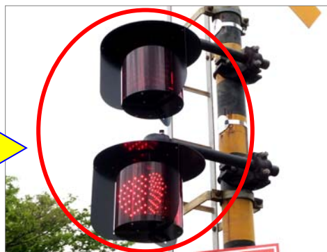
全方向踏切警報灯
