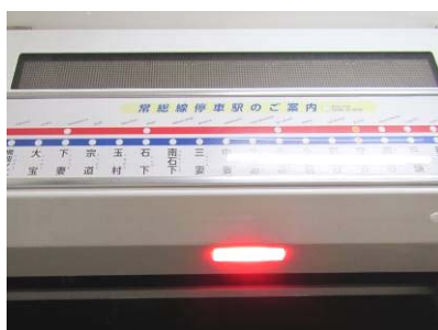
■戸開閉予告灯
