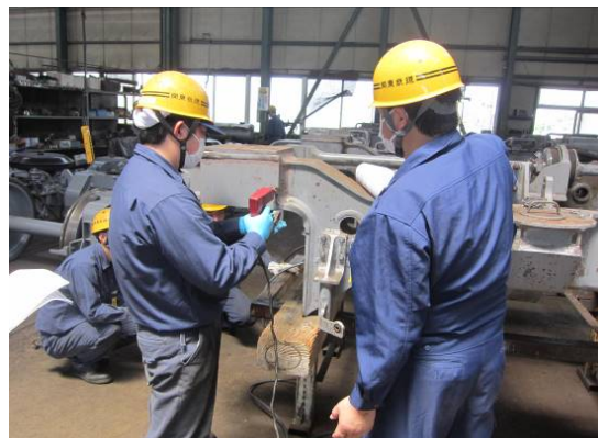
【検修区の台車枠探傷検査の教育】
