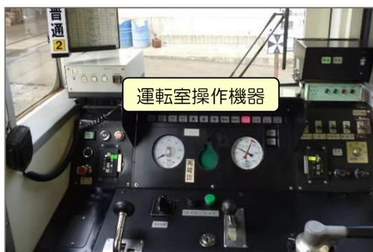
運転士が急な体調不良等で、運転操作が不能になった場合に列車を自動的に停止させる「運転士異常列車停止装置」を全車両に設置し安全性を向上させております。
