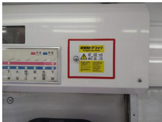
ドアの開閉時には乗務員が扉挟みなどに注意して開閉しておりますが、扉が閉まるタイミングで車内から急に降車されるお客様の事故防止のため、啓発ポスターを掲出し事故防止に努めています。また、非常用ドアロックの銘板をガイドラインに基づいた表示に変更し、万が一の時の操作方法について、日本語と英語で表示しております。
